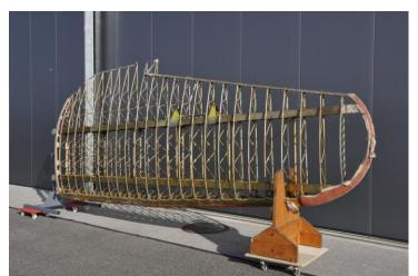
Les ailes sont absolument superbes et d'une construction unique avec des nervures en tube alu cintrées.
