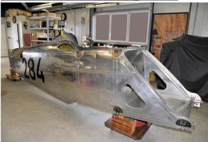
Le fuselage de construction semi-monocoque correspond à ce qui se fait encore actuellement. Avec une cellule en tous points comparables, les avions d'entraînement D.26 pouvaient être rapidement convertis en chasseur D.27.
